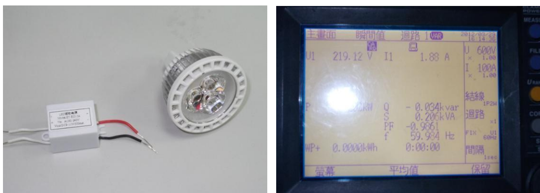
圖8.1-6 LED 光源外觀及耗電測試實照
