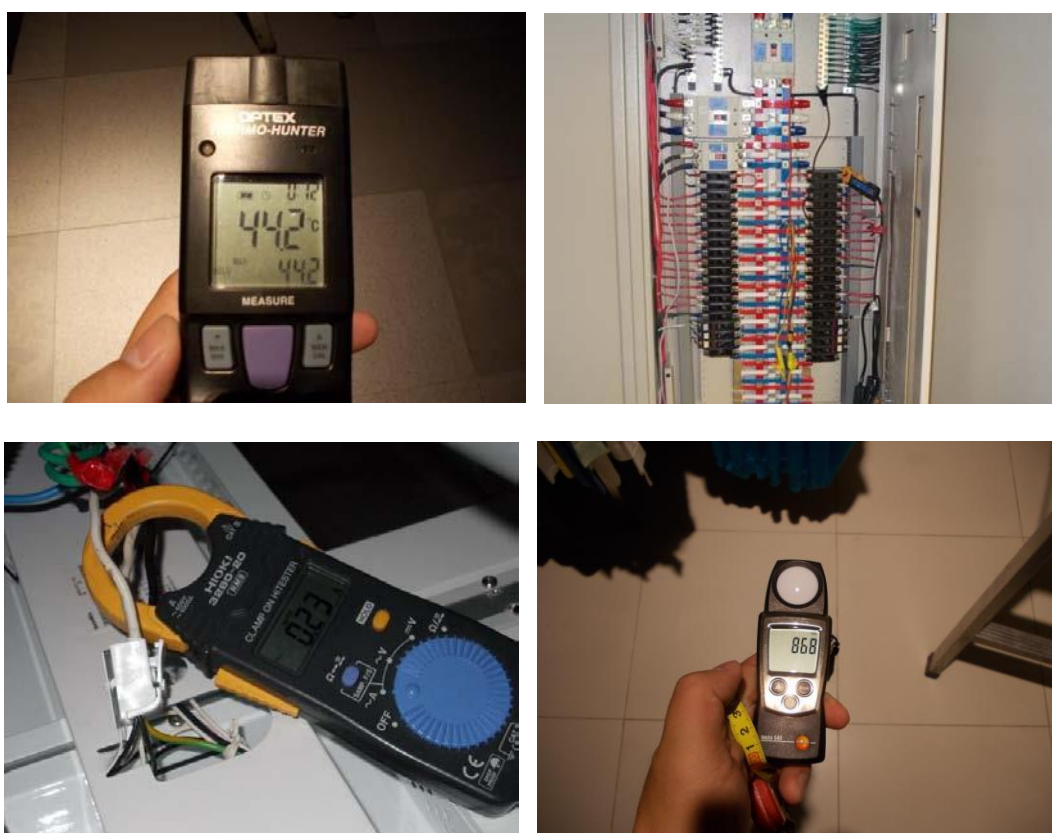
圖8.1-2 燈體溫度、照度與耗電實際量測圖
