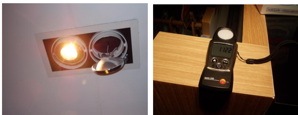
圖8.1-4 AR -111 型LED 光源外觀及照度測試實照
