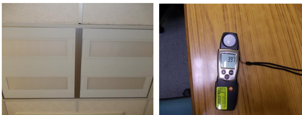
圖8.1-3 LED 平板型光源外觀及照度測試實照
