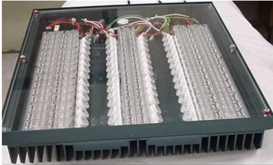
圖 2.4-8 以調整 LED 角度及位置達到照明效果的 LED 路燈
