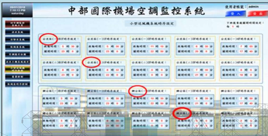
圖 4.1 小型送風機系統時序設定，公用1、公用2、辦公1及辦公2，五種不同的運轉模式。
