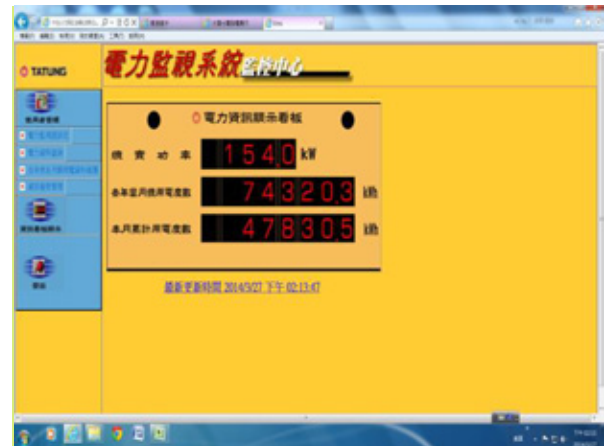
裝設數位電表監控全校用電
